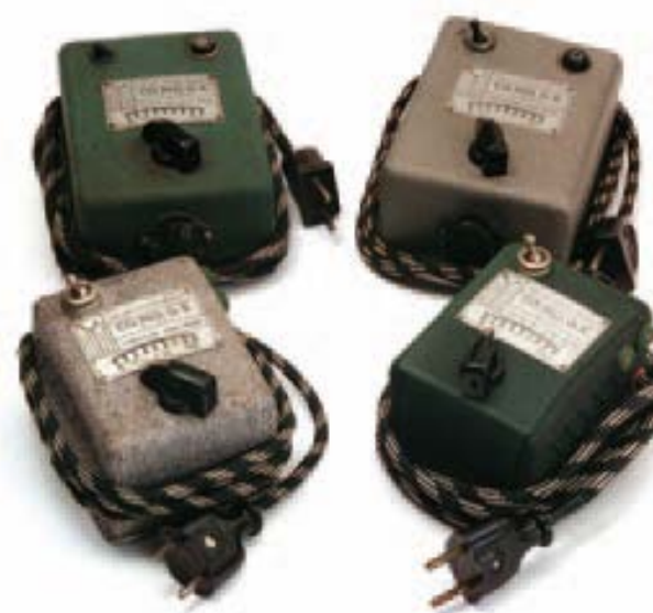
424 prime serie. 1946/1952 circa, primordiali da 15Watt in cassa metallica, reostato a cursore e deviatore per inversione. Colori vari. Teoricamente da 15watt dovevano essere solo quelli con cassa più piccola (in basso nella foto), ma talvolta erano impiegate anche le scatole più grandi previste per i 30watt.
