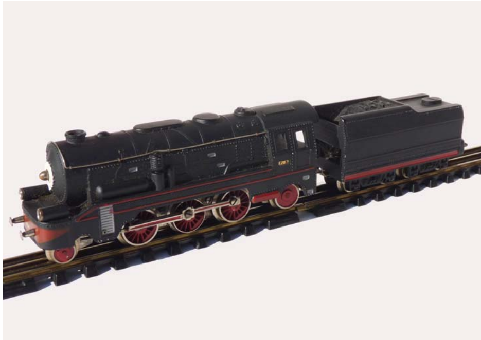
Opaco. Colorazione nero opaco, due fari sul pancone in luogo di quello in caldaia, biellismo articolato in lamierino leggero.
