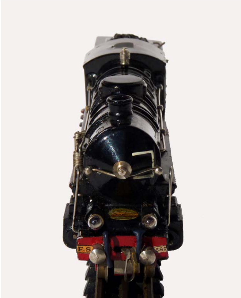
Fanali. Sul pancone anteriore sono alloggiate due lampade a gambo lungo a guisa di fanali: notare anche il particolare degli accoppiatori
