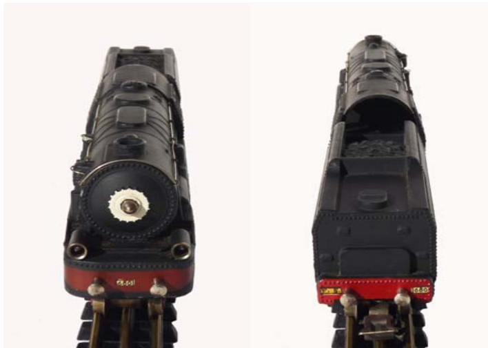
Opaco. Colorazione nero opaco, due fari sul pancone in luogo di quello in caldaia, biellismo articolato in lamierino leggero.
